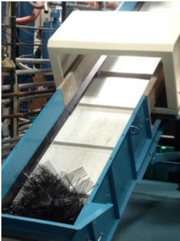
Les convoyeurs d'alimentation des broyeurs/déchiqueteurs de Bunting s'intègrent facilement dans vos installations existantes pour un transport efficace et économique des matériaux.
