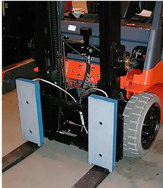
Gli elettro magneti stabilizzanti per carrelli elevatori sono progettati per trattenere i carichi in acciaio, trattenendoli in posizione contro le forche durante il sollevamento o il trasporto.
