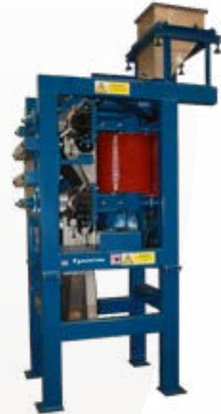
Induktionswalzenabscheider und Steuerung (500 mm breit, Maschine mit 2 Walzen)
