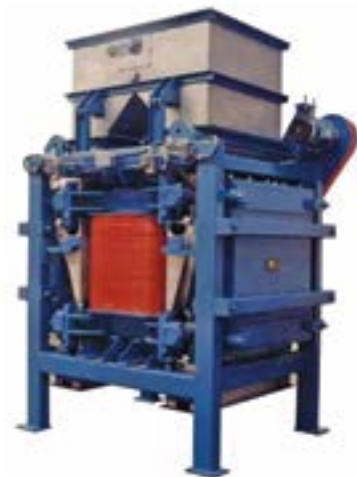
Induktionswalzenabscheider: 1 Meter breit, Maschine mit doppeltem Durchlauf zur Verarbeitung von Nephelinsyenit.
