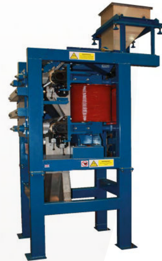
Separatore a Rullo Indotto e pannello di controllo (unità a 2 rulli di larghezza 500 mm)
