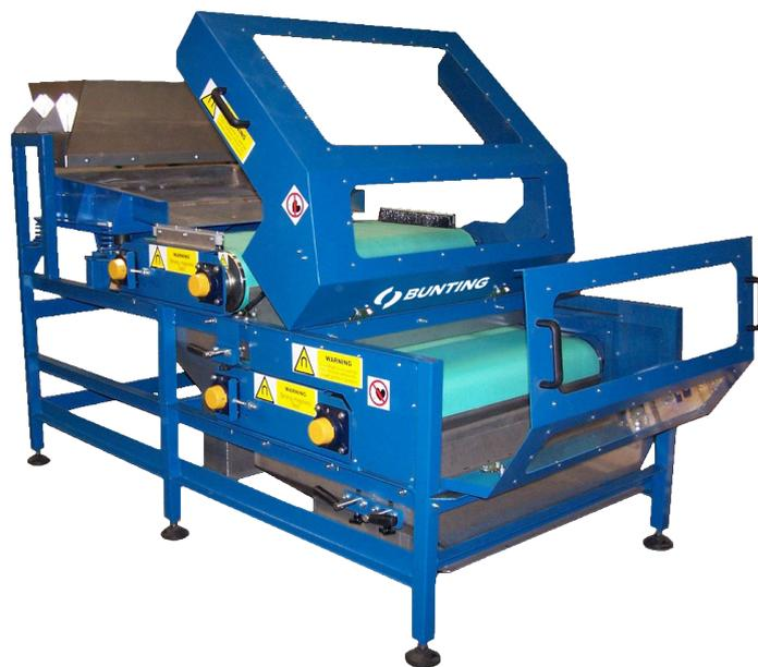
Die Bunting Seltenerd-Walze enthält Neodym-Eisen-Bor-Permanentmagnete, die zu den stärksten verfügbaren Magneten gehören und in eine Komposit-Magnetkopfwalze mit hoher Intensität eingebaut sind.
