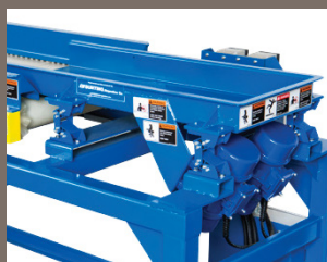
Vassoio vibratorio opzionale con piastre d'urto per i materiali pesanti
